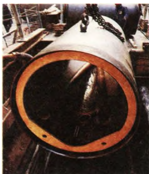
Труба из полимербетона со специальным профилем
