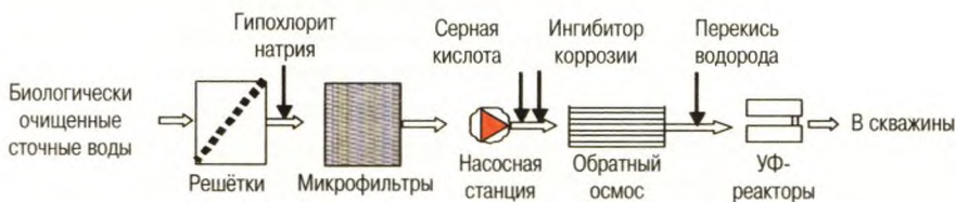
Схема обработки повторно используемой сточной воды Orange Country Water District Facility (Калифорния, США)
