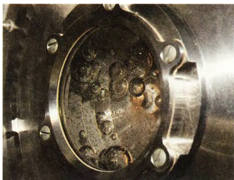
Пузырьки воздуха, объединяющиеся в воде, в сепараторе для системы электролиза
