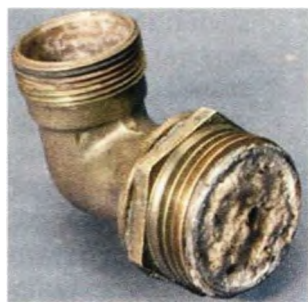
Накипь на внутренней поверхности труб
