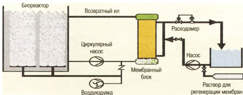
Биореактор с нагнетающим насосом, осуществляющим циркуляцию иловой смеси между биореактором и мембранным блоком
